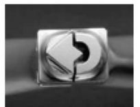
Arrow clasp bending plier.
